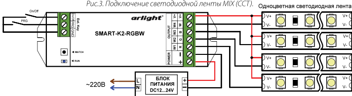
Рис.4. Подключение одноцветной светодиодной ленты. Ленты управляются синхронно.
